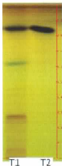
Figura 3. STUDII CALITATIVE COMPARATIVE , SISTEM PENTRU OLEUROPEINA, IN CARE: T1 – EXTRACT IN BUTANOL, T2 – COMPUS DE REFERINTA (ACID OLEANOLIC) (IDENTIFICARE CU VANILINA SULFURICA)
